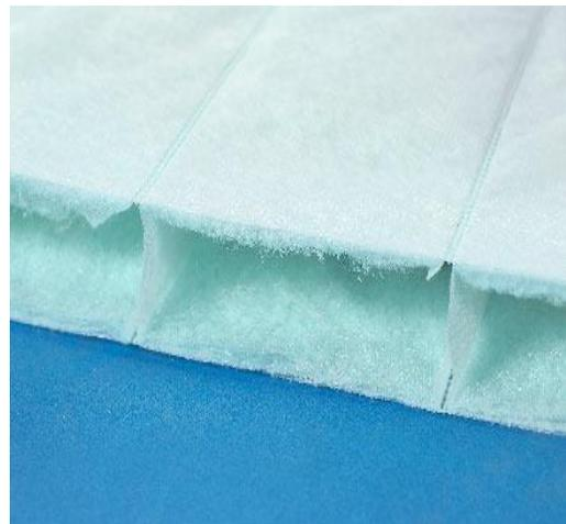
Utilizando la tecnología de espacios soldados continuamente (C.W.S.), se proporcionan 6 filas de espaciadores internos en cada bolsa, que permiten un inflado adecuado del filtro y por lo tanto una distribución uniforme de la corriente de aire, que da como resultado la completa utilización del medio filtrante, así como una resistencia inicial reducida.
